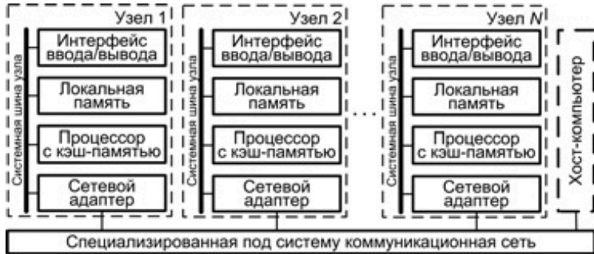
Рис. 14.5. Структура вычислительной системы с массовой параллельной обработкой
