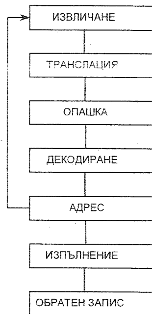
Фиг. 4-1. Структурна схема на конвейер с преобразуване на сложните команди в по-прости
