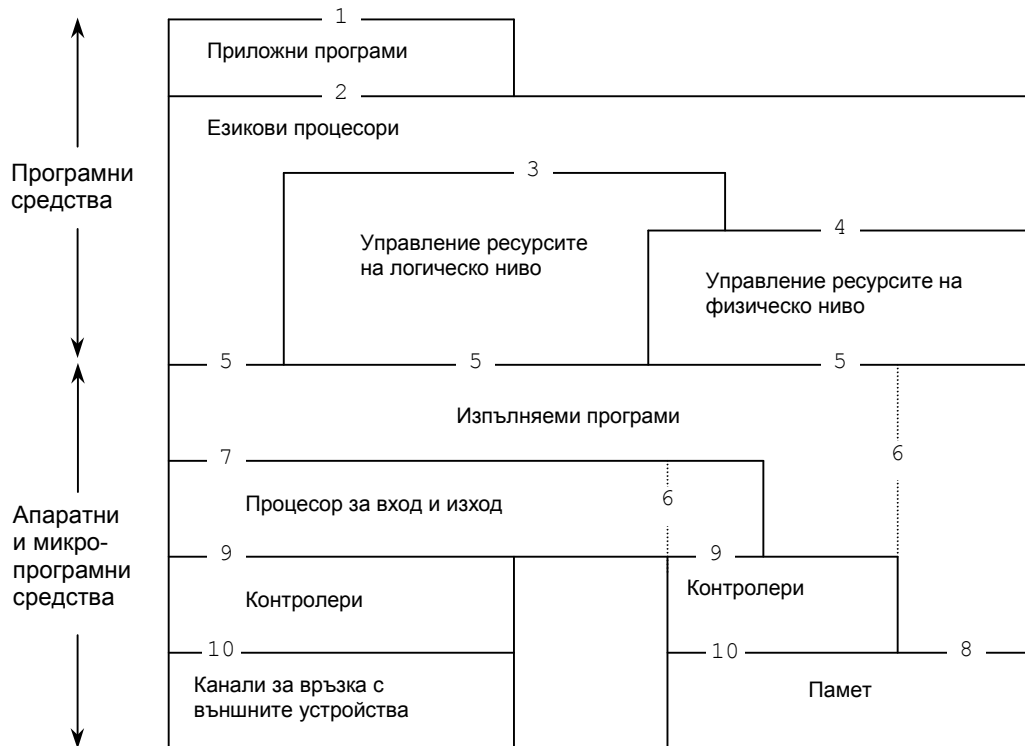
Фиг.1-1. Вертикална структура на архитектурата на конвенционален (последователен) компютър.
